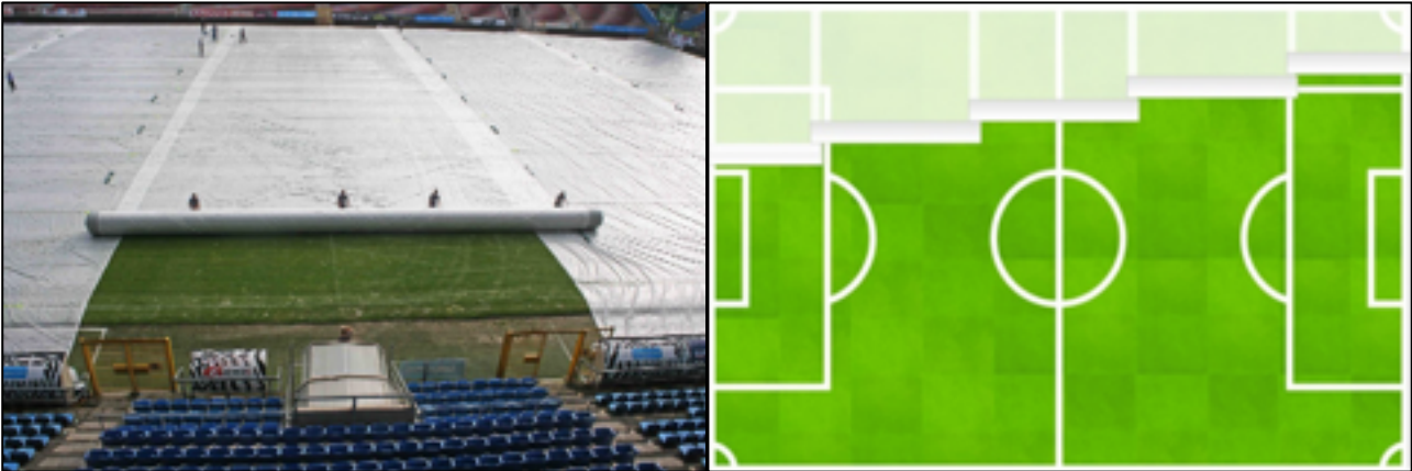
Matchsaver Air Roller System koostuu viidestä ilmatäytteisestä rullasta
